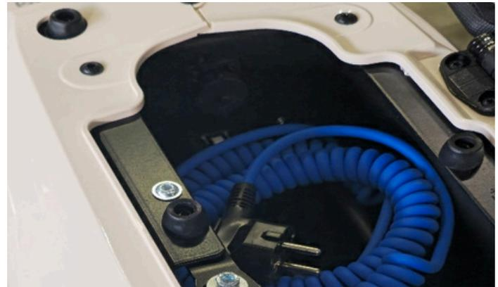
Um die Batterien zu laden, stellen Sie zunächst sicher, dass der Roller ausgeschaltet ist. Öffnen Sie anschließend den Sitz und verbinden Sie das im Staufach unter dem Sitz befindliche Spiralkabel mit einer Steckdose.
