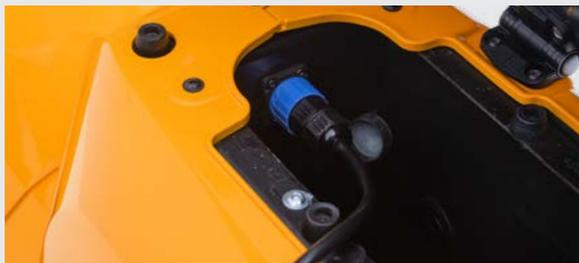
Während des Aufladens der Batterien im Inneren der eSchwalbe, wird der Status auf dem Cockpit-Bildschirm angezeigt. Wenn das Ladegerät nur mit dem Roller verbunden ist, aber nicht an die Steckdose angeschlossen ist, erscheint die Meldung im Cockpit „Check connection“ / „Verbindung prüfen“.
